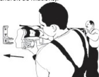
11) Fixez la poutre de structure du store avec des vis. M8x65 , et puis fixez le protecteur PVC.
