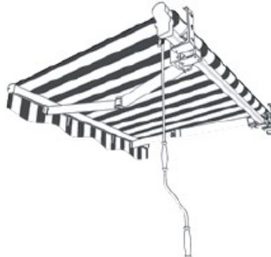
13) Si nécessaire, ajustez le niveau des bras en dévissant ou en serrant la vis interne M5 dans les supports des bras.
