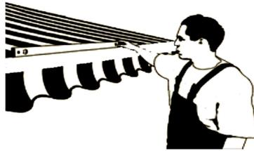
18) Après avoir modifié l'angle d'inclinaison, il faut penser à modifier la position du support du tube d'enroulement.
